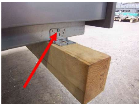
Foto van transportbalk aan bedienzijde, met de enkele schroef in het metalen frame zichtbaar.
